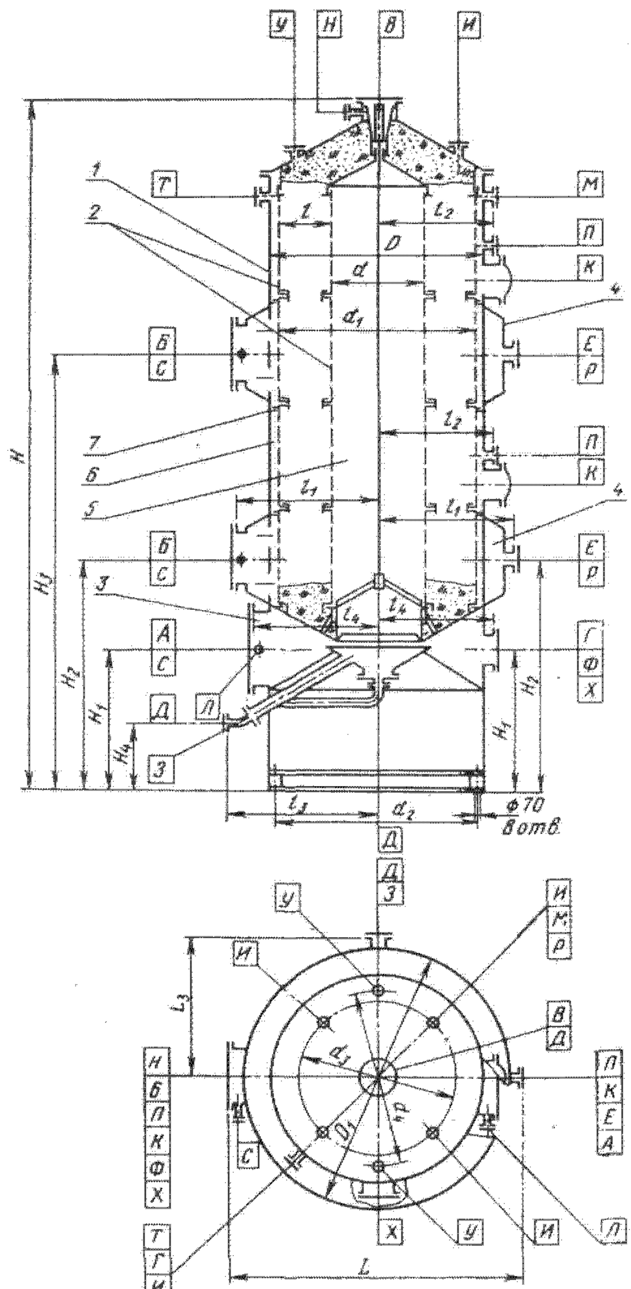
Рис. 50.3. Адсорбер, секционированный по условиям десорбции
