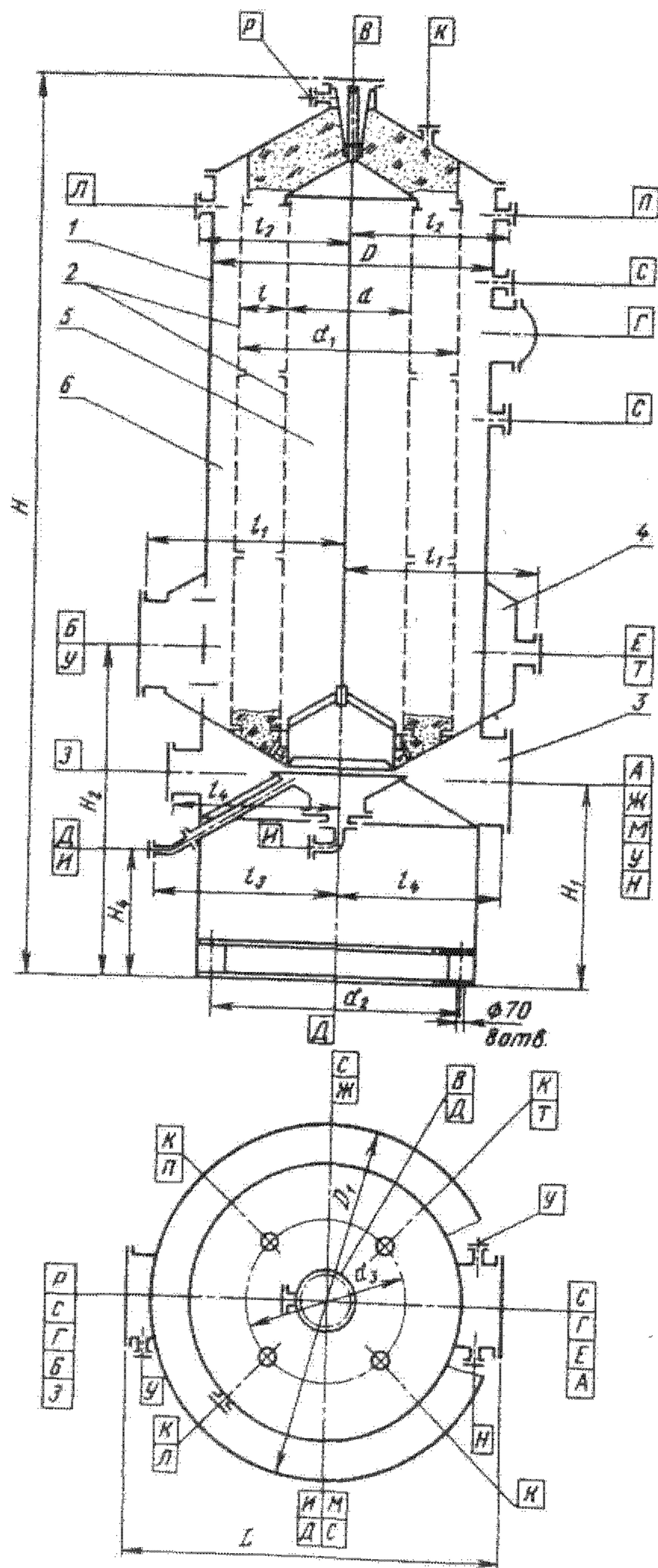
Рис. 50.2. Адсорбер, несекционированный по условиям десорбции
